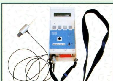
シロアリが木材をかじり纖維が切断された時に生じる微弱な振動波（AE）を感じ、食害箇所を検知。かじった回数が音や光、計数で表示され、部材の表面からは診断できない箇所や疑わしい場所の調査診断、駆除施工後の点検にも威力を発揮します。
