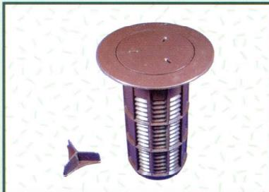
近くに棲息するシロアリを検知するためのユニット装置で、家屋周辺の地中に埋設して定期的に点検。中に木片を入れておき、シロアリが入っていたらバイオスペイトを投与、2~3ヶ月でユニットにシロアリがいなくなり駆除の完了を確認したら、再び定期点検を実施していきます。
